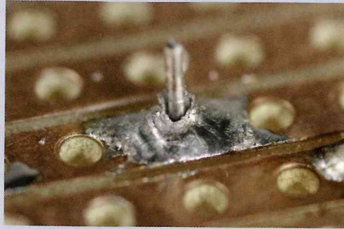
Kalte Lötstelle: Der Draht in der Mitte ist frei beweglich.
