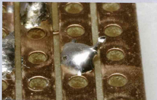
Schlechte Lötstelle: Das Anschlussbeinchen wurde vor dem Löten flach gebogen. Dadurch wird das Lötauge rechts blockiert oder die Gefahr besteht, einen Kurzschluss zu erzeugen.
