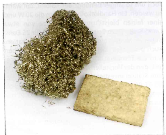
Abstreifschwamm und Messingwolle zum Säubern der Lötspitze
