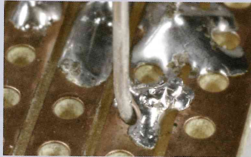
Schlechte Lötstelle: Der Draht ist nur angeheftet und wird nicht lange halten.
