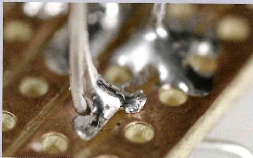
Schlechte Lötstelle: Verbindung zur angrenzenden Leiterbahn und Draht nicht vollständig umflossen
