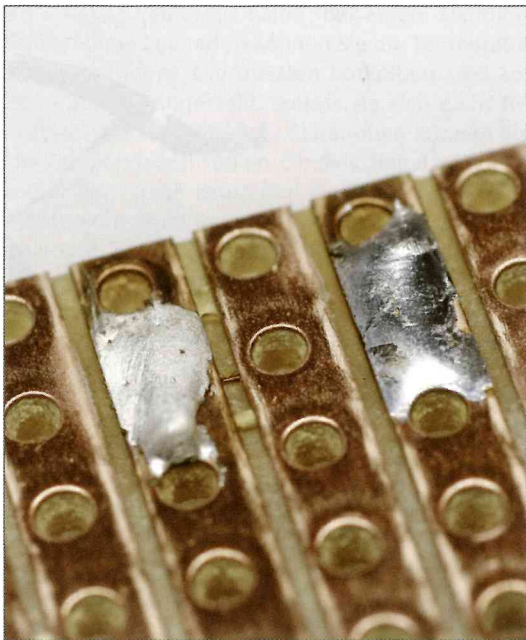
Lötstellen mit bleifreiem Lötzinn erscheinen matt und stumpf (links) während bleihaltiges Lot glänzend aushärtet.
