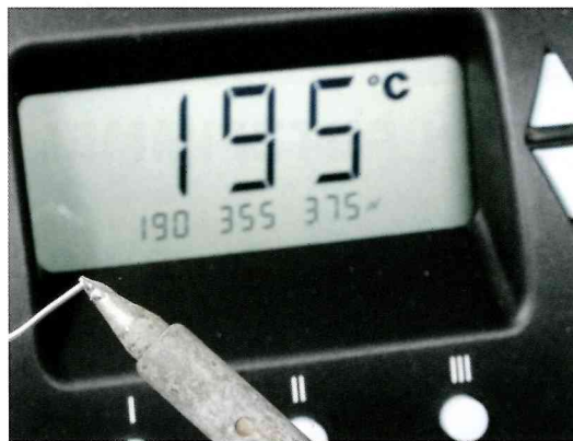
Ermitteln der Liquidustemperatur mit einer digitalen Lötstation. Die Anzeige stimmt fast genau mit der Solltemperatur von Sn60Pb40 überein.
