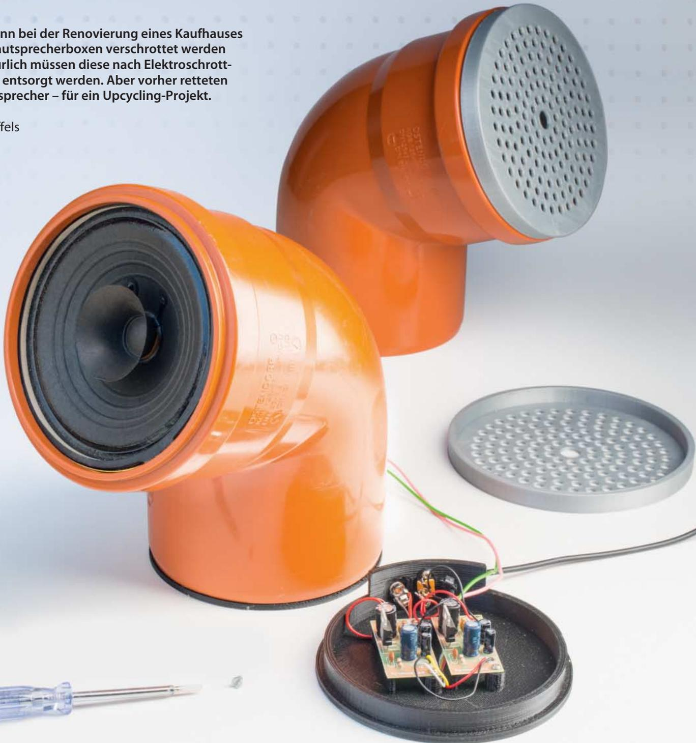
Aktivboxen mal anders – hier sind zwei Abflussrohrboxen mit zwei Verstärkerschaltungen zu einem Stereo-Paar kombiniert worden. Dabei sitzen die beiden Verstärker in einer Box.
