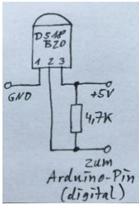
Ist das geschehen, muss nur noch der Sensor (oder mehrere) korrekt an den ARDUINO angeschlossen werden. Hier ist etwas zu beachten, sonst geht es nicht: Es muß ein sogenannter „PullUp-Widerstand“ vom Data-Pin des Sensors nach +UB geschaltet werden. Das ist schon alles. Das sieht dann so aus, siehe meine künstlerische Skizze.
