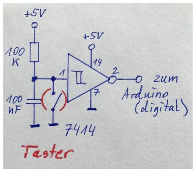
Der verwendete Schaltkreis ist ein 7414, welcher für ein paar Cent zu erwerben ist. Er enthält sechs Schmitt-Trigger, kann also auch maximal sechs Taster bedienen! Er ist so billig, dass sein Einsatz auch bei nur einem Taster gut ist. Die anderen fünf Schmitt-Trigger nutzt man eben nicht.
