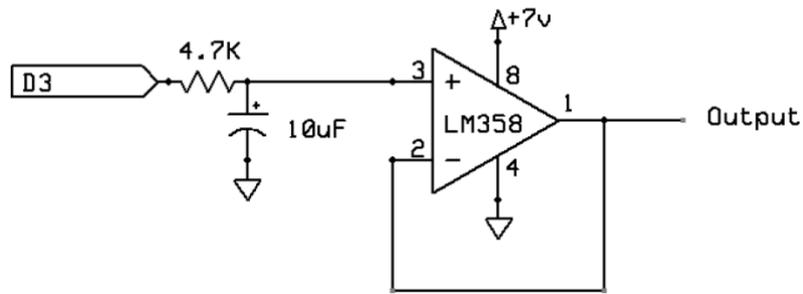
**Wichtig:** Der Kondensator C speichert Energie. Dadurch gibt es **eine zeitliche Verzögerung** vom Anlegen der Ausgangsspannung mit dem Befehl `analogWrite()` bis dieser Wert exakt am Ausgang des OPV anliegt. Das ist zu beachten! Gegebenenfalls die Funktion der Schaltung auf einem Steckbrett zusammenbauen und alles testen (idealerweise mit einem Oszilloskop) und bei Bedarf die Werte von R und C ändern. Man kann das alles auch kompliziert berechnen, aber dies soll ja ein Praxisbuch sein...
